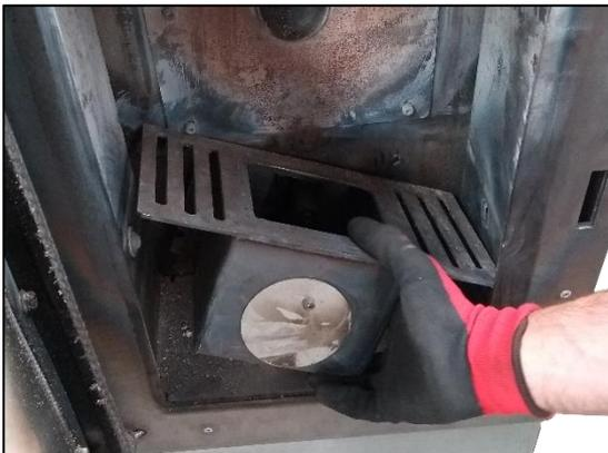
**Paso 3:** retire el soporte del brasero. Para ello ha de remover 4 tornillos que lo sujetan a la chapa frontal de la cámara de combustión.
