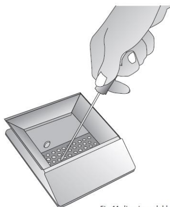
Fig.11: limpieza del braseo
