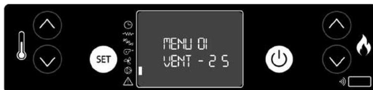
4. Om de ventilator van de kanalisering uit te schakelen, de snelheid op 0 zetten.
