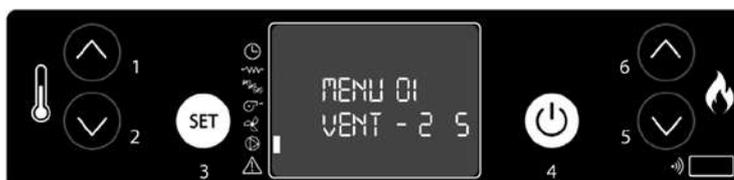
3. Impostare la velocità tramite i tasti 1 e 2. Con il tasto 1 si imposta la velocità del ventilatore di destra, con il tasto 2 si imposta la velocità del ventilatore di sinistra (tasto 2 nessuna funzione per questo modello).
