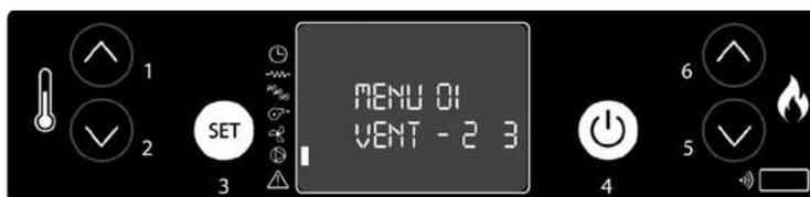
2. Premendo nuovamente il tasto SET si accede al menu per impostare la velocità del ventilatore della canalizzazione.
