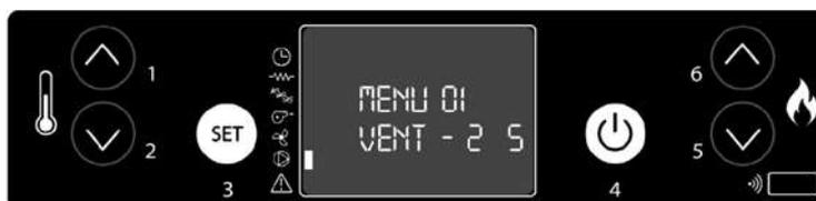
4. Per spegnere il ventilatore della canalizzazione, impostare la velocità a 0.
