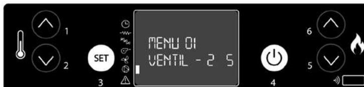
4. Para apagar el ventilador de la canalización, ajuste la velocidad a 0.
