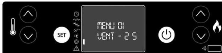
3. Stel de snelheid in via de toetsen 1 en 2. Met de toets 1 wordt de snelheid van de rechter ventilator ingesteld, met de toets 2 de snelheid van de linker ventilator (toets 2 heeft geen functie voor dit model).
