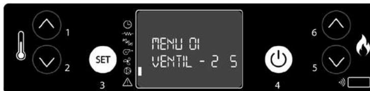
3. Ajuste la velocidad utilizando los botones 1 y 2. El botón 1 se usa para ajustar la velocidad del ventilador derecho y el botón 2 para ajustar la del izquierdo (el botón 2 no tiene una función en este modelo).
