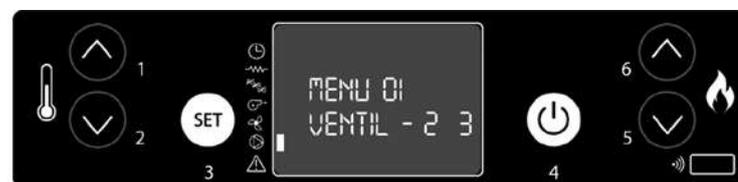
2. Volviendo a pulsar el botón SET, se accede al menú para el ajuste de la velocidad de giro del ventilador de la canalización.
