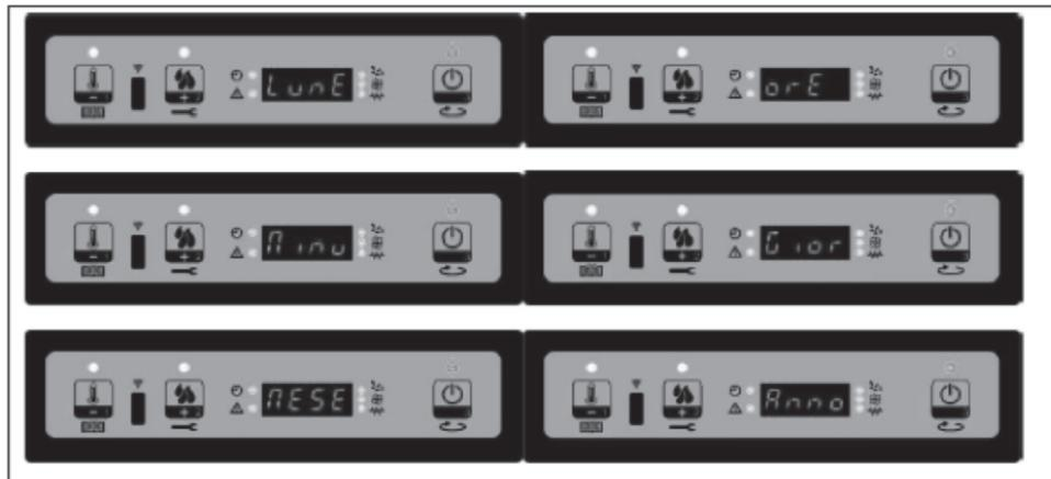
Choisir le jour souhaité et appuyer sur le bouton P3 (figure 13b), vous pourrez régler l'heure (figure 13c), les minutes (figure 13d), du jour (figure 13e), mois (figure 13f) et l'année (figure 13g) en utilisant les boutons P1 (baisse) et P2 (haut) et en confirmant votre sélection à l'aide du bouton P3.
