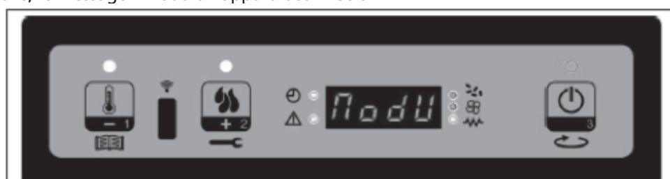
Si la température ambiante descend en dessous de la température définie (température définie), le poêle revient en mode «Lavoro» et à la puissance paramétrée précédemment (puissance définie).
