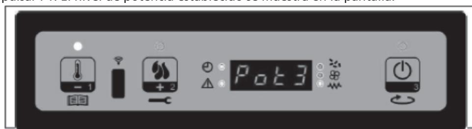
Para salir de la configuración, esperar 5 segundos sin realizar ninguna operación en el teclado, o pulsar P3.
