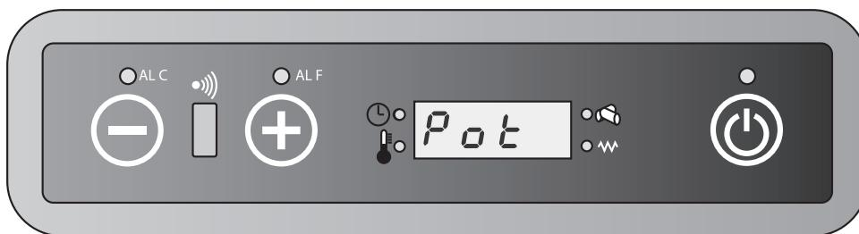
1. Pritisnite gumb 1, da se pokaže meni za nastavitev temperature. Na zaslonu se izpiše "SET" in vrednost nastavljene temperature.
