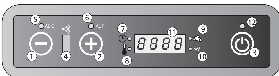
Tipka 1: S to tipko znižate želeno temperaturo. Uporablja se tudi za prikaz in spremembo stopnje sproščanja toplice.
